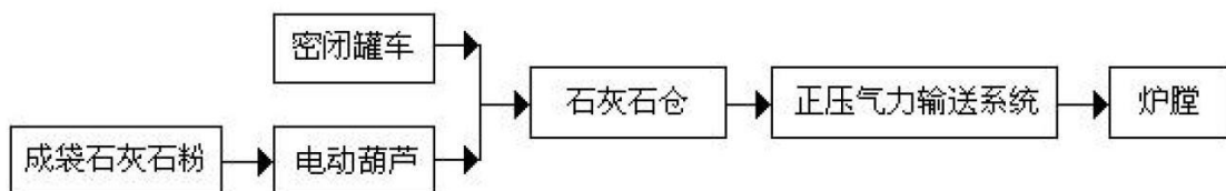
图 2.4-4 石灰石输送系统工艺流程示意图
