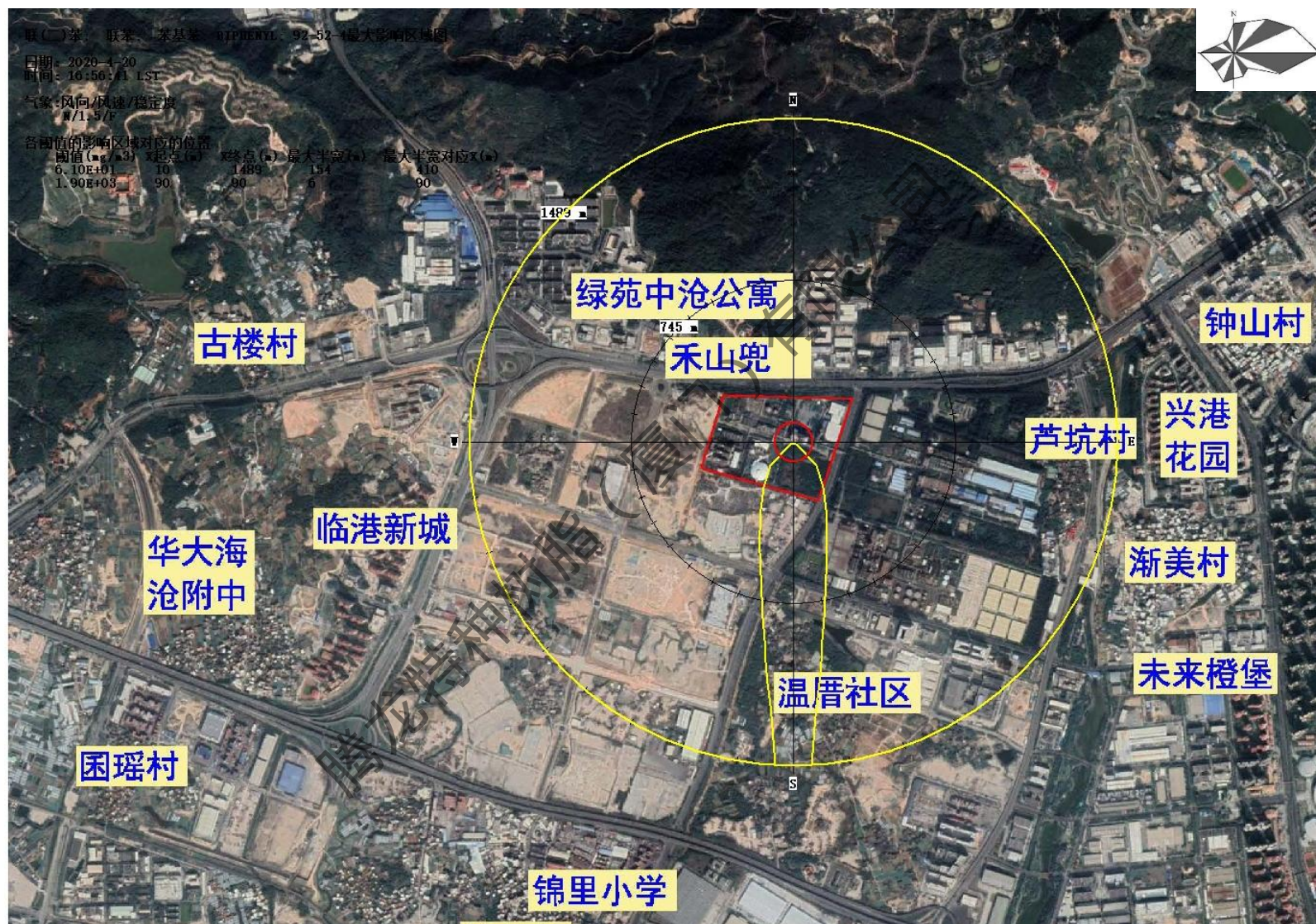
图 4-7 联苯泄漏极端气象条件下影响范围示意图
