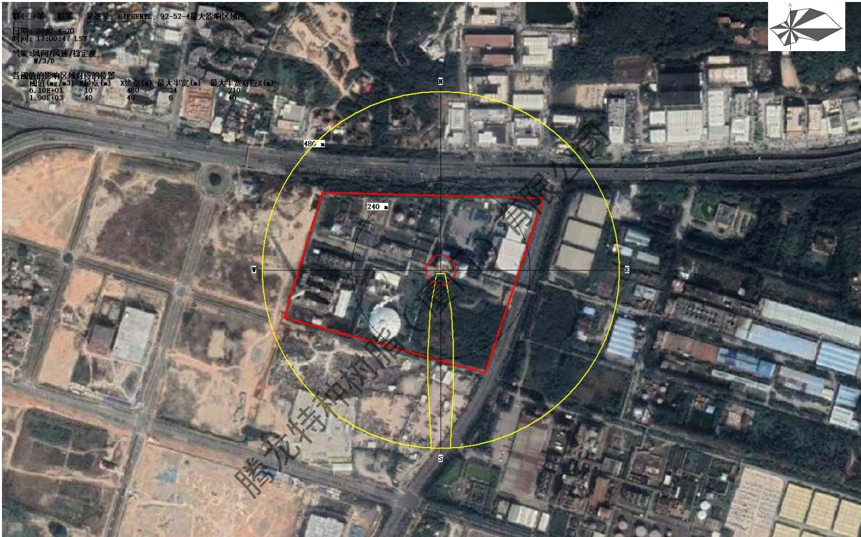
图 4-8 联苯泄漏常规气象条件下影响范围示意图
